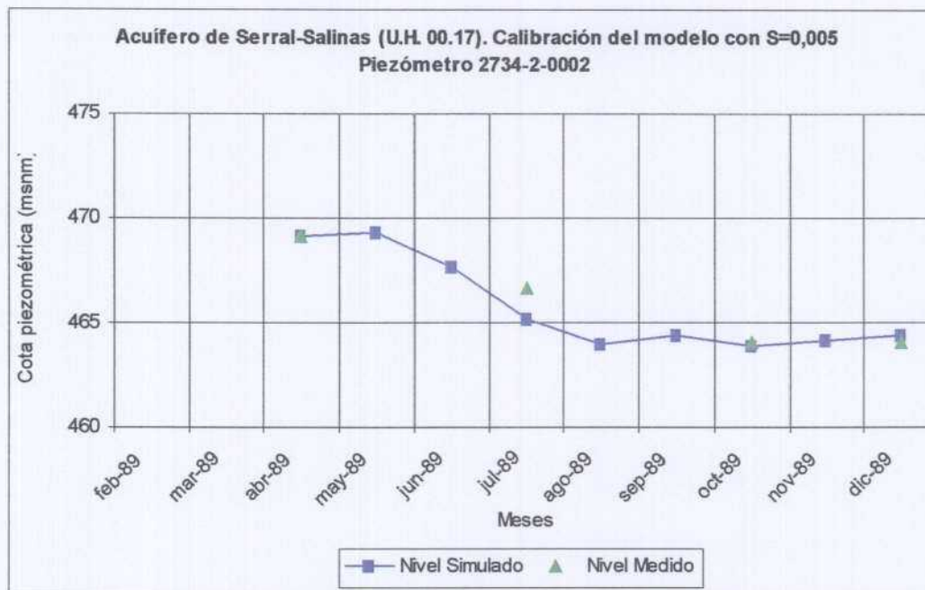
Figura 24. Calibración del modelo con M=1,87 , N=0,21 y S=0.005
